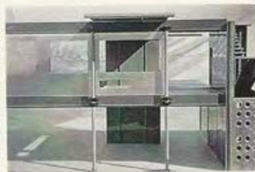
Maqueta de un inmueble HBM de cinco pisos, realizable con solamente trece tipos de piezas independientes.
